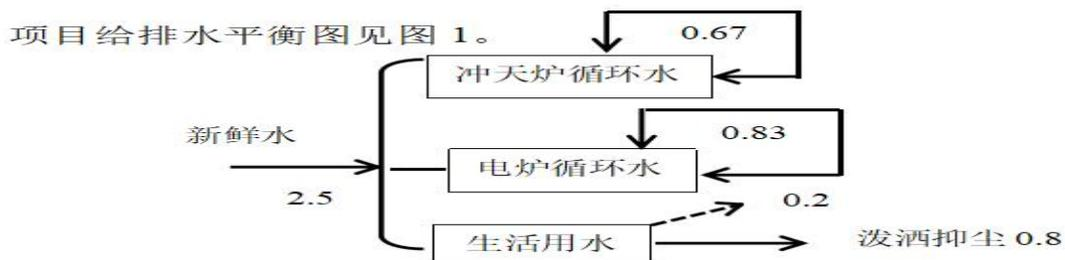
图 2-4 全厂水量平衡图 单位 m<sup>3</sup>/d
