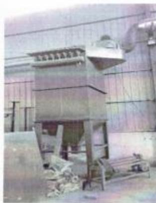
图 9. 焊接、打磨工序布袋除尘器
