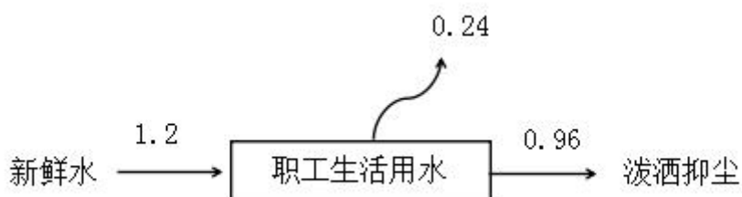
图 2-6 项目给排水平衡图 单位：m 3 /d
